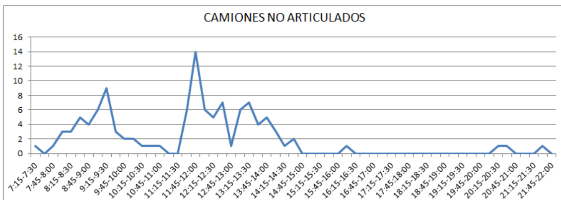
Ilustración 168: Evolución del tráfico de camiones por intervalo de 15 min en punto de cámara Miovision.
