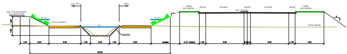
En las zonas de transición entre secciones (desde la salida del marco de la A-7 hasta el inicio del encauzamiento y desde el final del tramo a cielo abierto hasta el inicio del marco) se definen unas secciones especiales para que la corriente se adapte progresivamente al cambio de sección.
