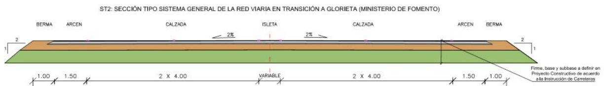
En los primeros 30 m del SGRV tenemos una sección de transición entre el acceso a la glorieta del ministerio y la sección tipo general caracterizada por un abocinamiento que provoca la existencia de 2 carriles por sentido de 4 m de ancho, a los que exteriormente se acompaña con un arcén de 1,50 m y una berma de 1 m e interiormente con un arcén-isleta de ancho variable.
