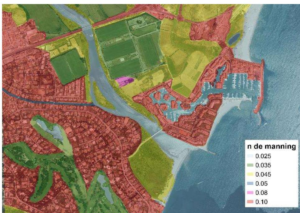
**Figura 6.** Zonas diferenciadas en planta en función de su rugosidad
