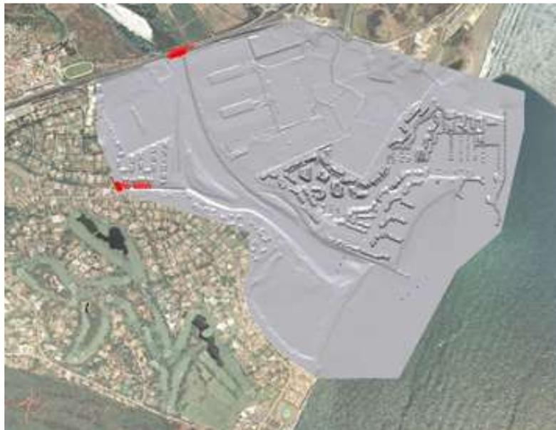
**Figura 9.** Elementos a los que se le asignaron las condiciones de contorno de entrada
