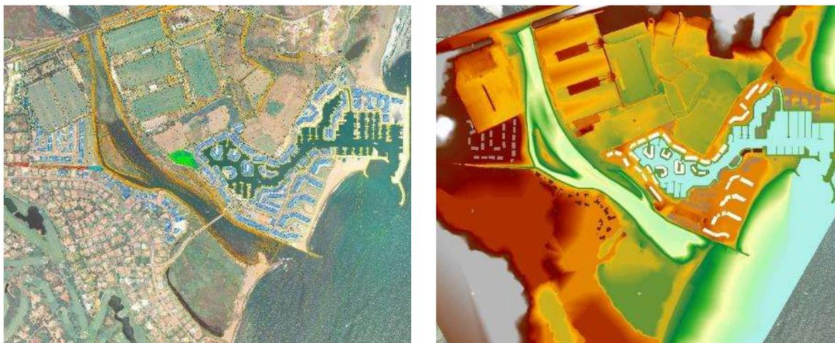
**Figura 3.** Cartografías utilizadas (izquierda) en la construcción del Modelo digital del terreno (derecha)
