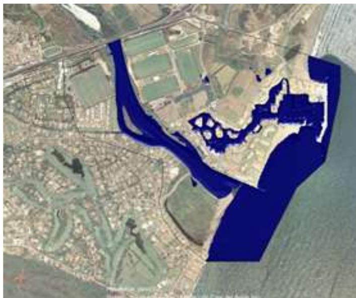
Figura 8. Situación inicial del modelo (cota de agua 0,90 m.s.n.m.)
