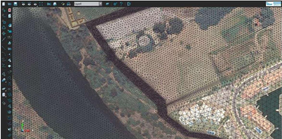
*Figura 5. Detalle de diferentes mallados del modelo Iber en la margen izquierda del río Guadiaro*
